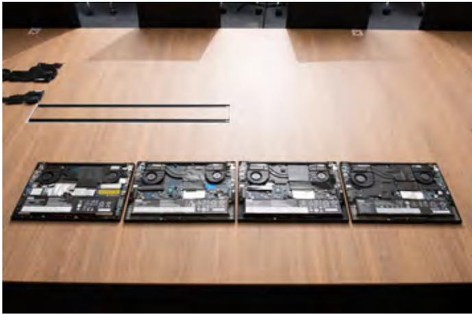
ThinkPad P1の冷却機構。写真左から第3世代、第4世代エントリーモデル、同ミッドレンジモデル、同ハイエンドモデルの冷却機構
