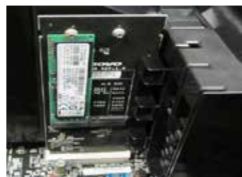
M.2 SSD対応FLEXアダプターの装着状況
