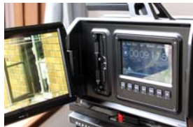
液晶画面を3つ搭載したBlackmagic URSA。ストレージのスロットは画面を開いた中にある
