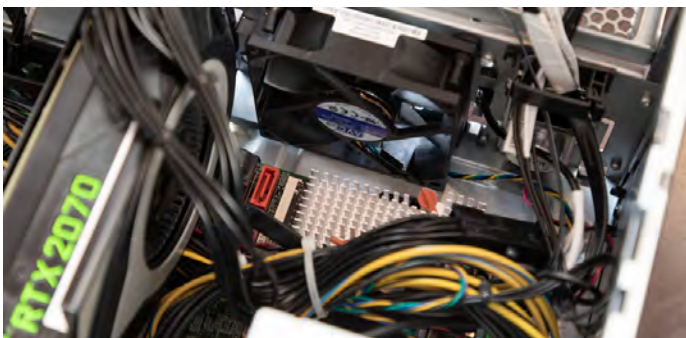
「GPUボードの発熱/ファンによる空気の流れを意識した本体ファンの位置取りが絶妙」と鈴木氏は言う。
