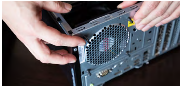
ファンの振動・振動音を吸収する小さなゴムラバーからも、開発者たちの徹底したこだわりが伝わってくると、鈴木氏は評価する。
