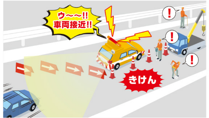
後方接近車両検知システムの概要 出所：パトライト
