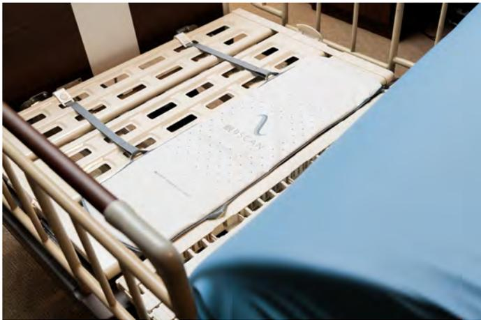
介護施設の既存の電動ベッドにセンサーを設置可能
