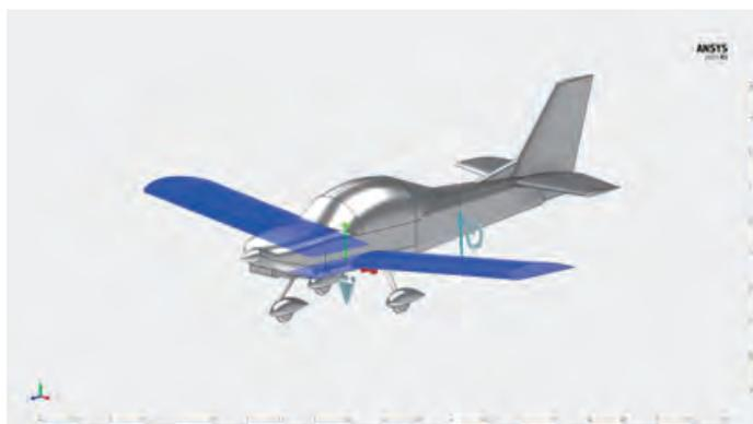
図2: 検証の環境条件～飛行機の底面の一部を完全拘束とし、主翼全体に揚力を想定した上向きの荷重を与える～
