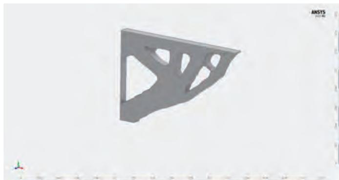
図7: トポロジー最適化の解析で求められたジオメトリ
