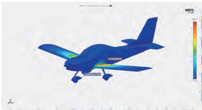
図3：応力分布の例（「Von Mises相当応力」の解析結果例）
