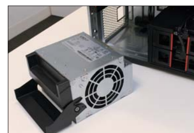
取り替え可能な電源ユニット ※写真はP710/P510
