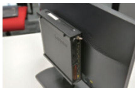
ソリューション②のオプションを利用しモニター背面へ装着したケース。さらに光学ドライブを搭載することも可能。
